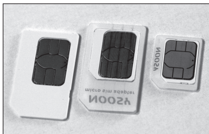
Obrázek 1.2 MiniSIM a menší formáty v adaptérech
