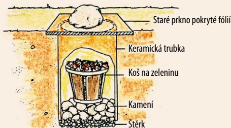
e) Uskladnění v hlíněné trubce (12)
