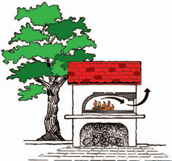
Obr. 12 Obezdní pícky nejen prodlouží využití tepla, ale vytvoří z ní hezkou zahradní stavbičku; pícka s odkouřením dvířky
